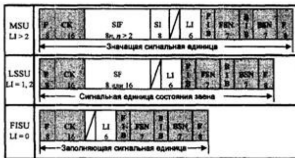
Рисунок 5 -Формат сигнальных единиц (цифрами обозначено количество бит в каждом поле)
